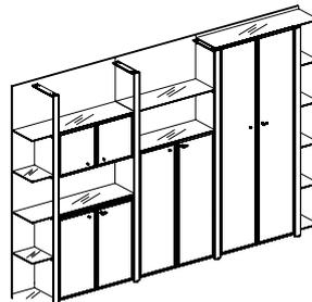
Les ensembles boiserie peuvent être équipés avec portes mélaminé ou en verre dépoli avec cadre alu, en quatre hauteurs différentes. Les portes hauteur 83,27 et 211cm peuvent être installées seulement au niveau du sol. Les portes hauteur 45cm peuvent être installées à toutes les hauteurs.
