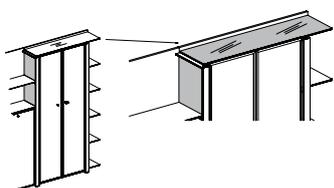
Avec les portes hauteur 211cm il est nécessaire de fermer la partie supérieure avec une étagères
