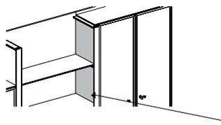
Lorsque la Boiserie est équipée avec portes il est nécessaire de fermer toutes les deux parties avec des côtés de fermeture qui doivent être installés entre les étagères et les montants. Les côtés de fermeture peuvent être utilisés aussi pour diviser les espaces dans les étagères.
