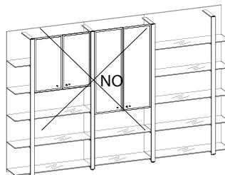
Les portes hauteur 83 et 127cm ne peuvent pas être installées dans la partie supérieure
